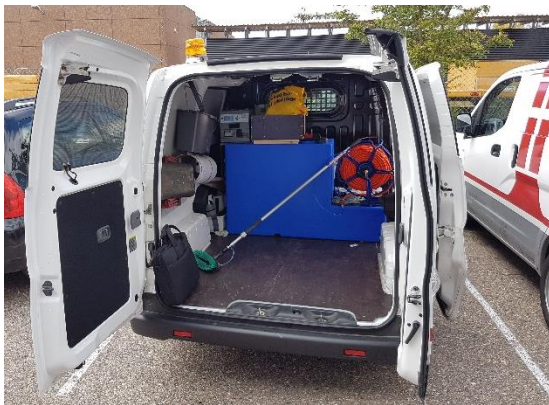
Figur 1. Et kig ind i en af AFA JCDecaux' 7 ENV-200 elvarebiler. LPS enheden er den grå kasse over den blå vandtank.
